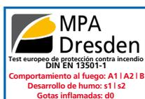
El renombrado instituto para ensayos de materiales MPA de Dresden ha sometido los tejidos JUTEC® a un ensayo según **DIN EN 13501-1** (Comportamiento frente al fuego de los productos para la construcción y elementos para la edificación) según un nuevo **ensayo de protección contra incendios válido para todos los países europeos.**
