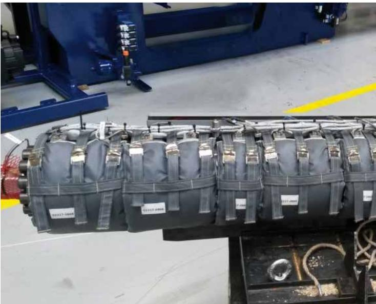
*Revestimiento para espiral calefactora (antes del montaje final)*
