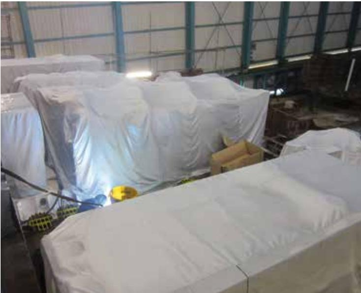
*Cubiertas para equipos durante trabajos de soldadura en astilleros*
