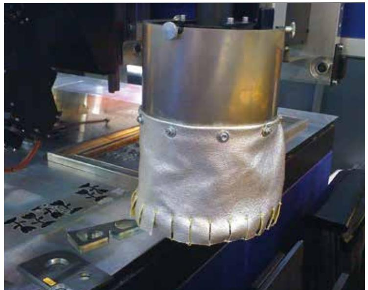
*Protección antideslumbrante para cabezales de corte en equipos de plasma*
