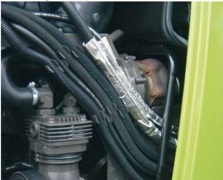
*Cubiertas protectoras para conductos hidráulicos*
